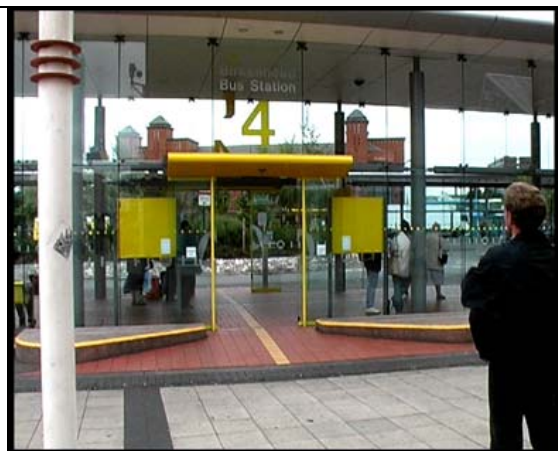
Bilde 150 Liverpool, Storbritannia. Birkenhead Bus Station har tydelig markerte innganger og samtidig god markering av nivåsprang. Her er det ca 8 oppstillingsplasser for buss rundt et bygg. Det er glassvegger, og man ser fra alle deler av bygget når bussene stiller opp utenfor.
