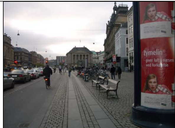
Bilde 7 , København. Slette stein til å gå på (og trille på) og hvilebenker gir gode forhold for fotgjengere. Denne bruken av slett stein gir også et ryddig gatebilde som tydelig viser hvor det er ment at en skal gå (og hvor en ikke skal plassere reklame), og gir samtidig en taktill og visuell støtte for synshemmede.
