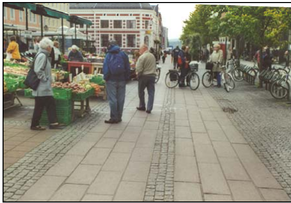
Bilde 62 Gågate/torget i Kristiansand. Ulike felt for plassering av elementer. Kjørefelt med jevne heller for rullestol. Kantmarkeringer i brostein som kan brukes som naturlig ledelinje for synshemmede. Sykkelparkering er plassert i sone med eget belegg. Også torghandel er avgrenset med en annen type kantstein, noe som bidrar til at ferdselsarealet er rent for mulige hindringer.
