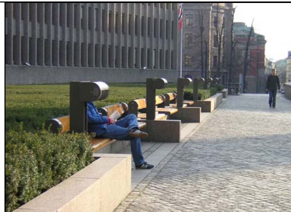
Bilde 31 Akersgata, Oslo. Her er benkene trukket fint ut av gangbanen, men materialbruken er gjort omvendt, ved at det er glatt dekke under benkene, og gatestein i gangbanen. Dette gir ujevn gå/kjøreflate. Det er også egen belysning til benkene.
