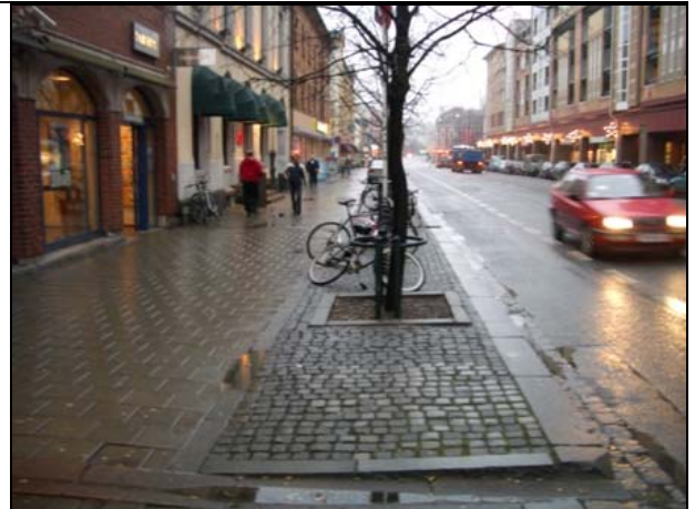
Bilde 78 Grønland, Oslo. Her er et godt norsk eksempel inndeling av fortauet i soner. Trær, benker, sykkelstativ osv står i møbleringssone ut mot gata, og det er et bredt og bekvemt ferdelsareal mellom møbleringssonen og husfasadene. Det er sykkelfelt i gata. Denne utformingen er ca 14 år gammel? Men fortsatt et av de beste eksemplene for et hensiktsmessig og godt utformet gatetverrsnitt.
