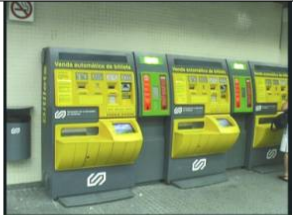
Bilde 171 Automater i Barcelona. Her er det riktig høyde og skjerm og betjening er kraget ut så en rullestolbruker lett kommer inntil.
