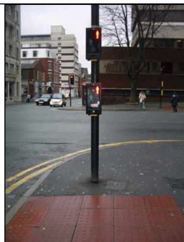
Bilde 96 Manchester, Storbritannia. Signalanlegg på samme side som angir rødt/grønt for synshemmede. Angivelsen er i to høyder, man tar hensyn til nærsynte.
