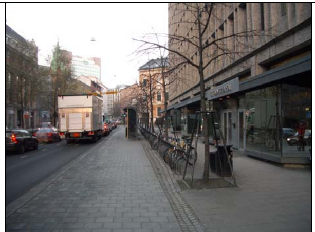
Bilde 103 Pilestredet, Oslo. Sykkelparkering i sone bak selve holdeplassarealet. Ideelt sett burde parkeringen også ha hatt en avgrensning på den delen som vender inn mot den delen av fortauet som er mellom parkeringen og husveggen.
