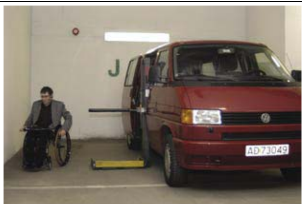
Bilde 105 Illustrasjon fra Norges Handikapforbund. Sidemontert heis krever god bredde.
