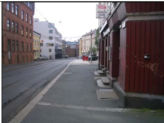
Bilde 79 Pilestredet, Oslo. En vanlig situasjon med trappeutspring og lave kanter inne ved veggen som kan gi snublefare. Her skulle det ha vært en veggzone.
