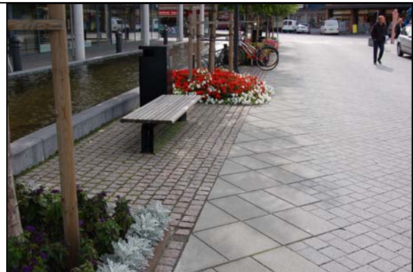
Bilde 32 Bratsberg brygge, Porsgrunn. Eksempel på en møbleringssone, hvor benker, trær, sykkelstativer og søppelkasser er samlet i en stripe ved siden av gangbanen. Her er det riktig materialbruk med gatestein i møbleringssonen og jevne heller i kombinasjon med låsestein i gangbanen.
