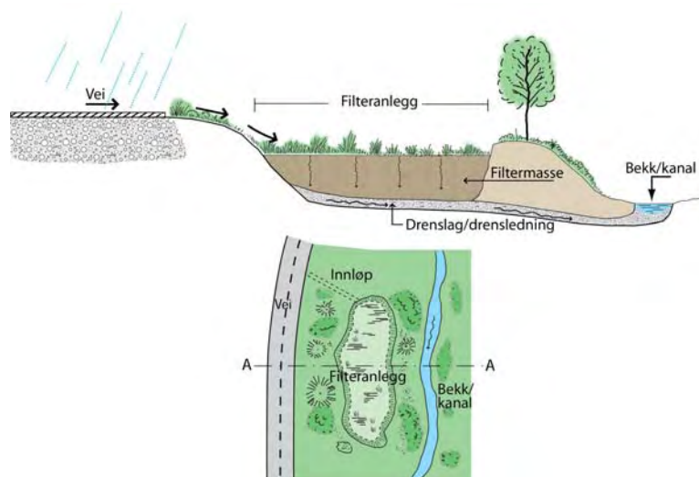
Figur 403.6. Utforming av åpent filterbasseng (plan/snitt)..
