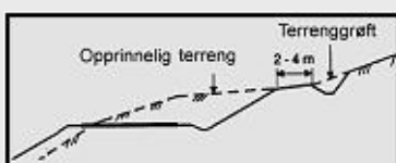
Figur 413.1 Plassering av terrenggrøft
