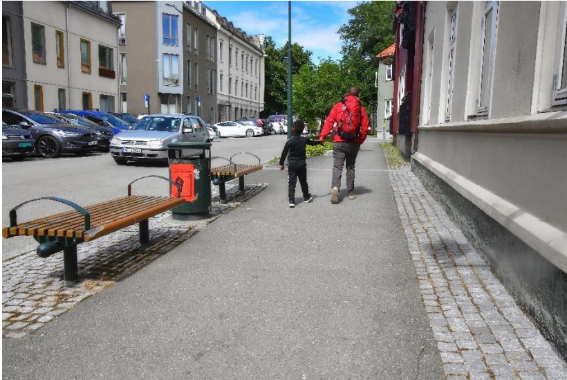
Figur 2. Dette fortauet har god universell utforming. Ferdselssonen er jevn, fast og skliskker mens veggsonen og møbleringssonen har en ruere og lysere overflate (Foto: Knut Opeide, Statens vegvesen)
