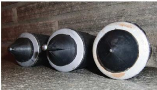
Figur 7.14 Til venstre pakkere med stift i spissen av enveisventilen. Pakker med gummimansjett fremfor krysskåret spiss som her har ikke denne muligheten. (Foto [81]) Til høyre eksempel på markering av hullkontakter under injeksjon i Storhaugtunnelen i Stavanger.
