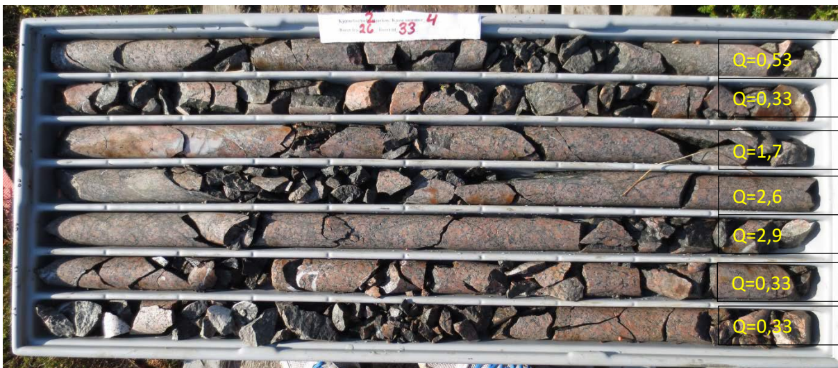
Figur 2.3 Bilde av borekjerne fra Bjarkøy. Bildet viser oppknust og forvitret granittisk gneis. Q-verdi pr boremeter er vist til høyre i bildet. (Foto: Edvard Iversen)
