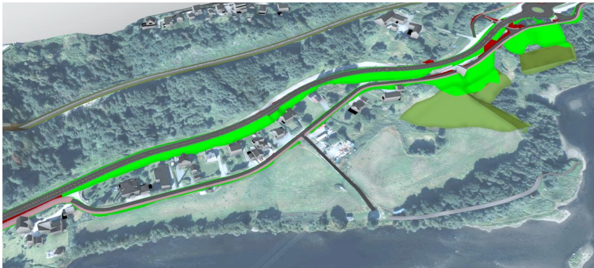
Figur 45: Alternativ A – I sørlig ende av planområdet etableres det sykkelveg med fortau.
