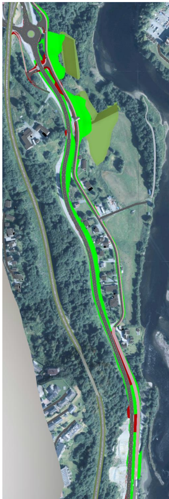
Figur 28: Planskisse alternativ A, fra modell. Arealer forbeholdt syklende og/eller gående (rosa farge), skjæringer (rød farge), fyllinger (neongrønn farge) og motfyllinger (olivengrønn).
