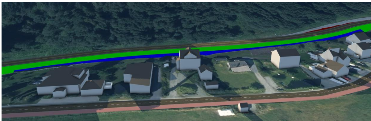
Figur 25: Omtrentlig plassering av mur (blå skravur) og fylling (grønn skravur) mot boliger i Sivert Dahlens veg. Støyskjerm vil komme i tillegg.
