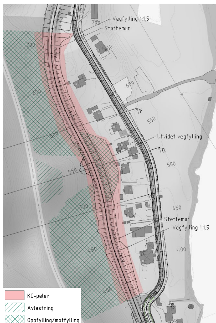
Figur 7.1 Justert A2 vegtrasé med nødvendige stabilitetstiltak
