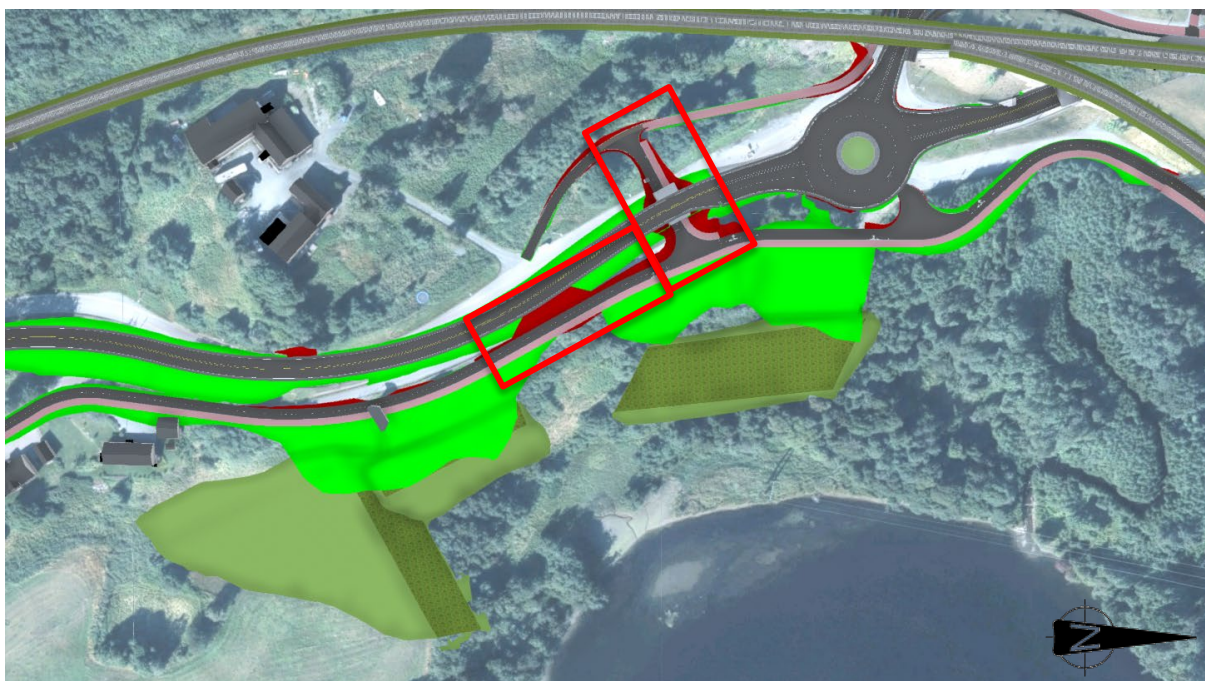
Figur 5-2 Utsnitt fra modell for alt. A2: områder med mulig behov for grunnforsterkning (skissert med rødt)
