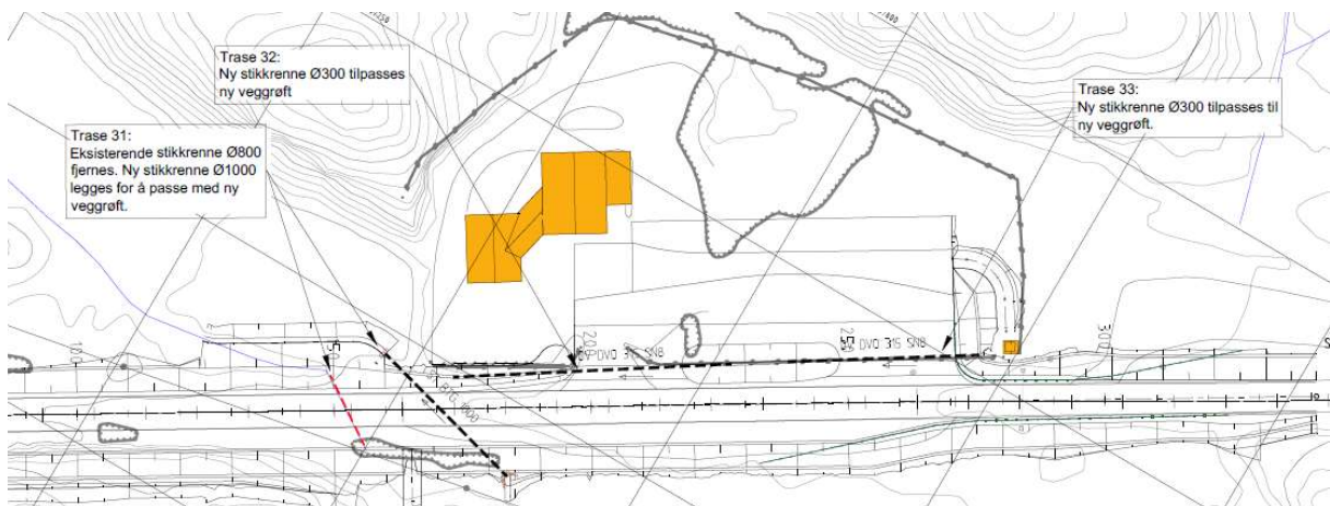
Figur 34. Utsnitt fra G-tegning som viser plassering av eksisterende (røde) og nye (svarte) stikkrenner innenfor planområdet
