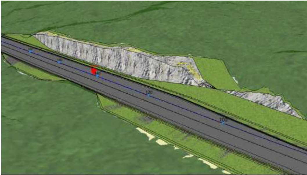
Figur 32. Utklipp fra vegmodell i Nova Point som viser planlagt bergskjæring ved Trollvann
