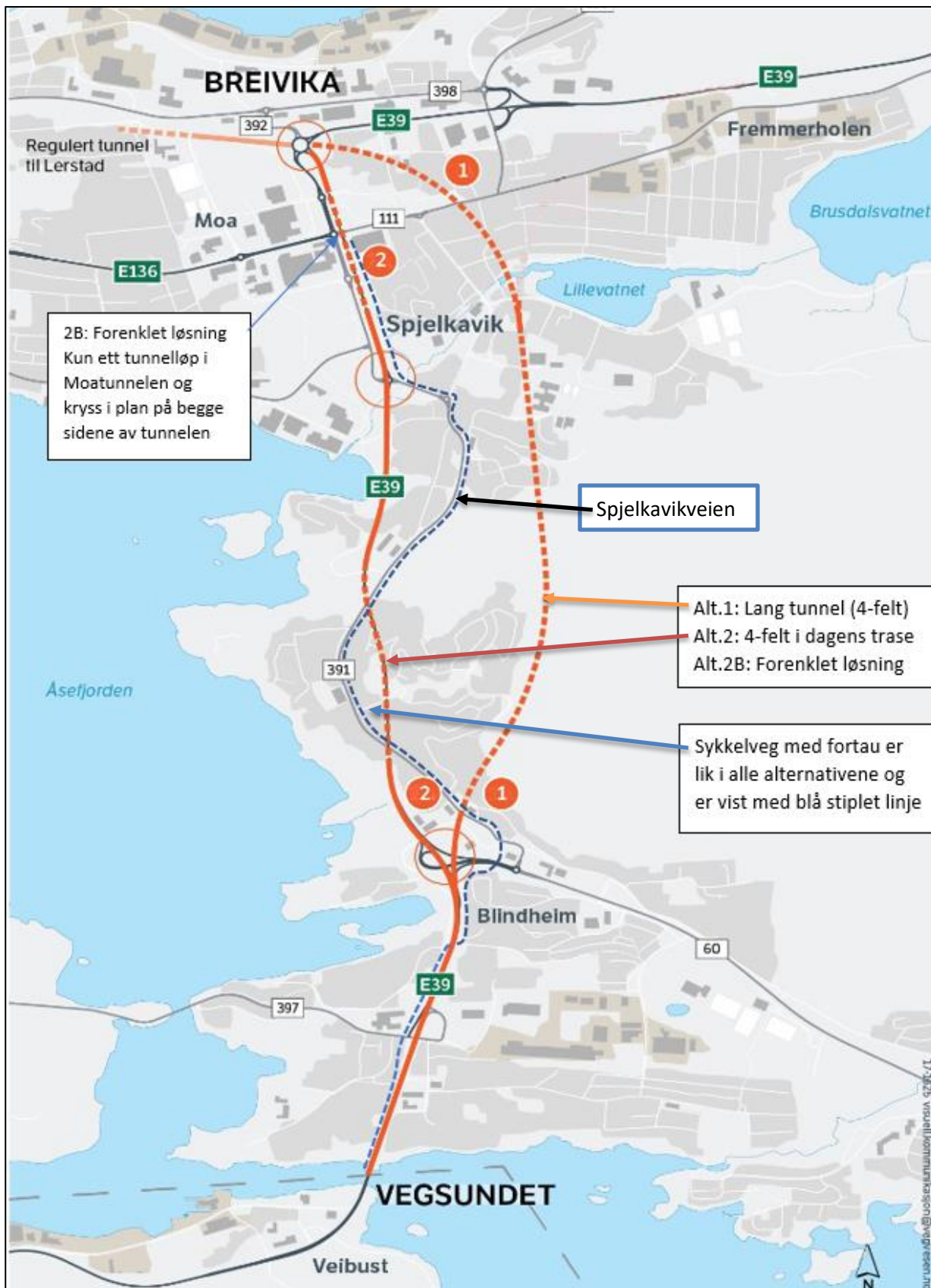
Figur 3 – Oversiktsfigur som viser de viktigste forskjellene mellom alternativene. Mens alternativ 1 utgjør en ny 4-felts tunnelloøsning fra Blindheim til Breivika, så er alternativ 2 en utvidelse av dagens E39 fra 2 til 4 felt.
