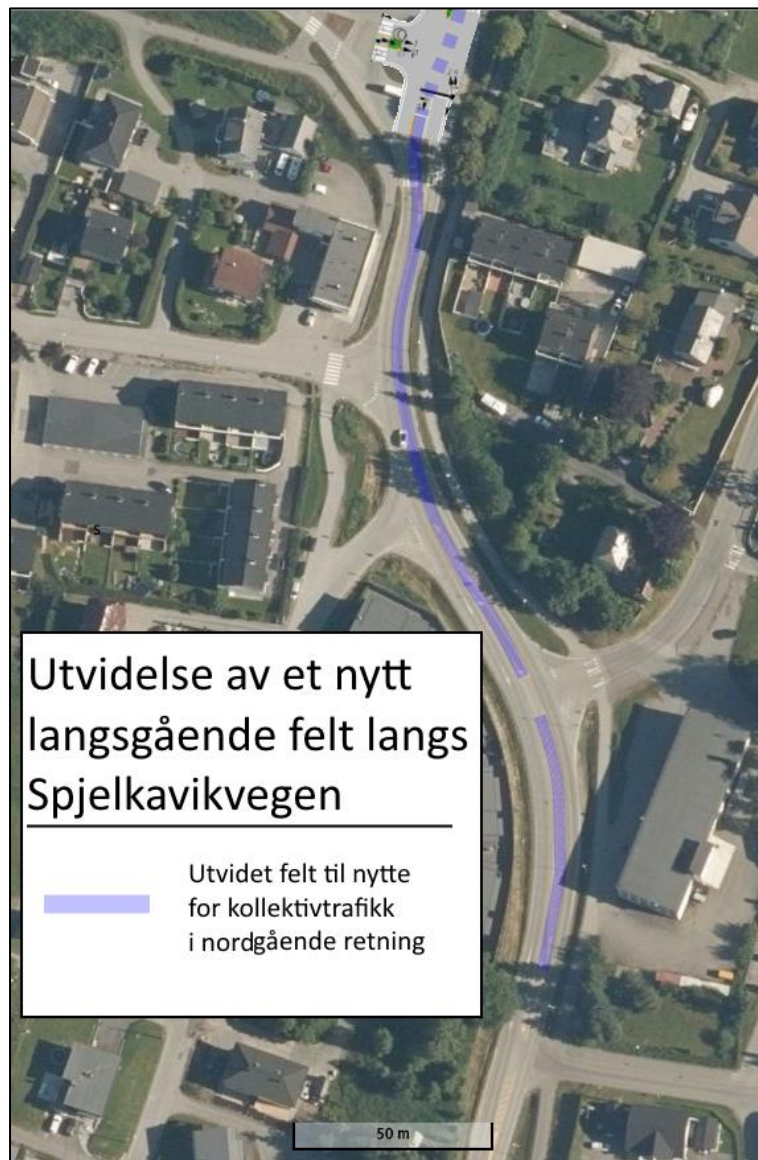
Figur 35 - Forslag om utvidelse av Spjelkavikvegen mellom Mogensvegen og Nedrevollbrua i nordgående retning.
