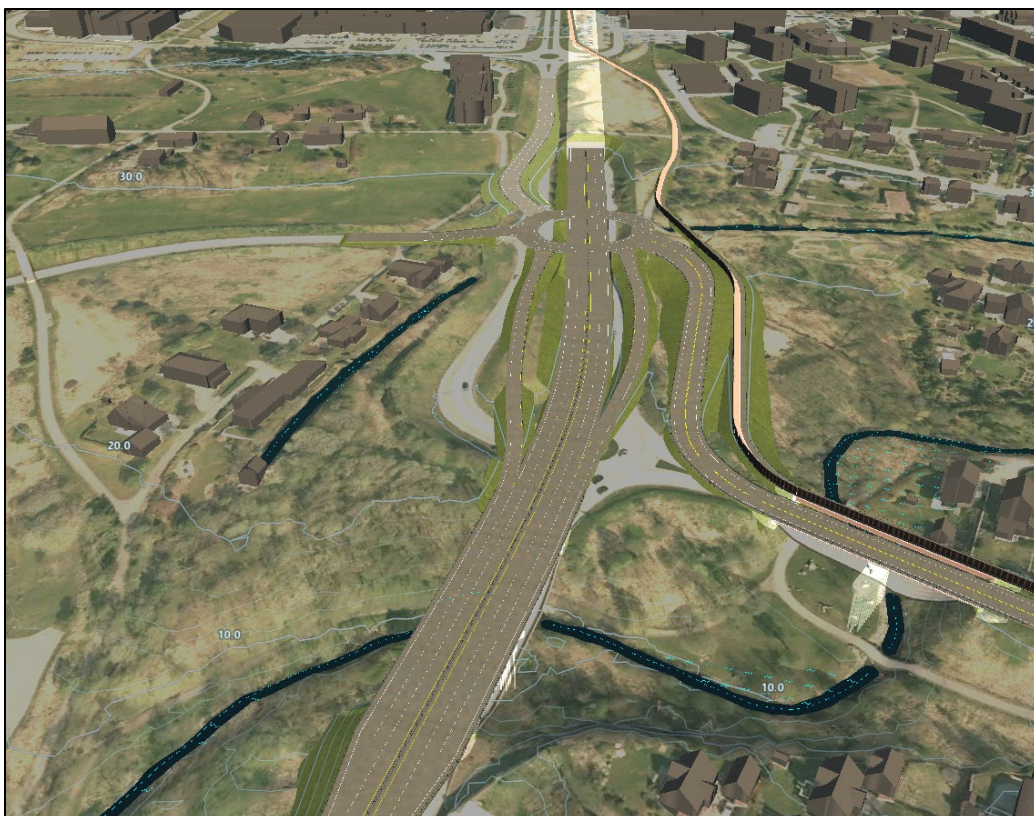
Utsnitt som viser kryssløsning i Spjelkavik som ikke krever fravik for rundkjøring på riksveg.
