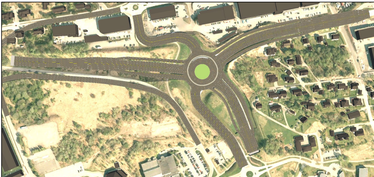
Utsnitt fra Infracore som viser kryss med to rundkjøringer over hverandre i Breivika
