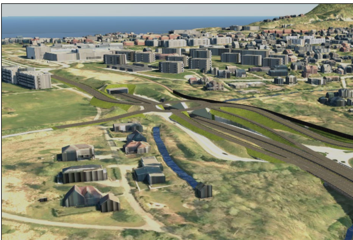
Utsnitt fra Infracore som viser kryssløsning i Spjelkavik som ikke krever fravik for rundkjøring på riksveg.
