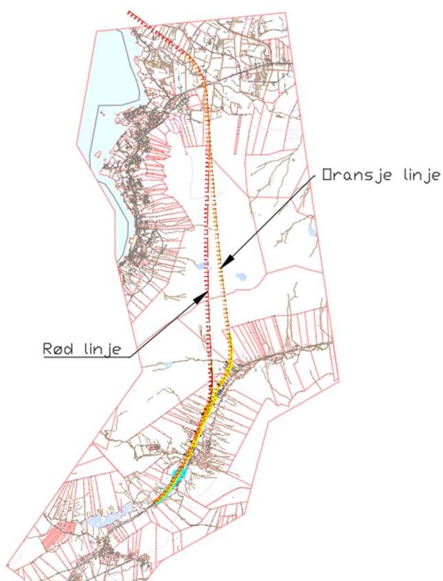
Figur 1 De to alternative traseene på strekningen Ørskogfjellet - Vik. Den røde linjen er illustrert til venstre og den oransje til høyre.
