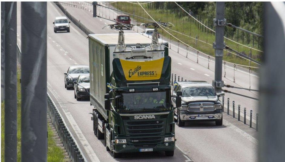
Scania parallellhybrid med EuroVI-motor og el-motor med kraft levert fra 100 kwh batteri ladet fra ladeledning og pantograf
