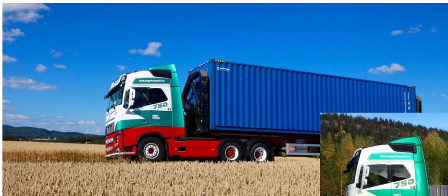
Trekkbil med 45 fots container på chassis
