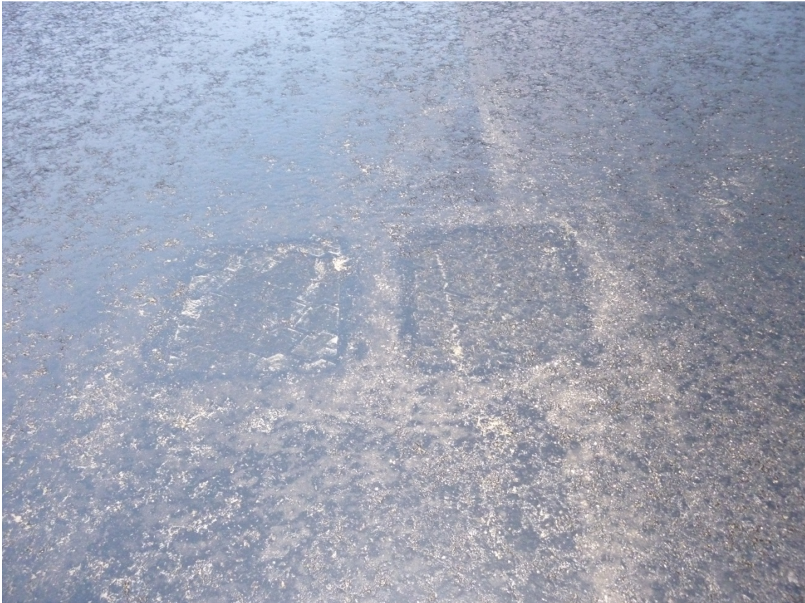
Bilde 2: Ska 16 PMB – avtrykk på avkjølt asfalt
