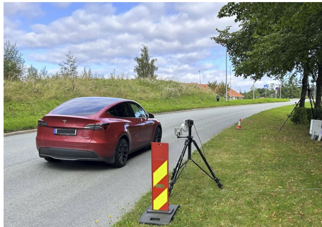
Figur 3-1. Målelokasjon 4. Radar og kamera i forgrunnen. Instrumentskap og mikrofonsystem bakgrunnen.
