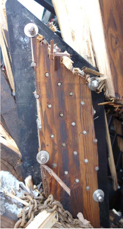
Eksempler på blokkutriving på Perkolo bru
