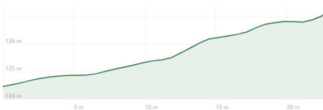
Figur 12. Terrengmodell / lengdeprofil av tilgjengelig strekning bekk 6 oppstrøms planlagt/ny kulvert.
