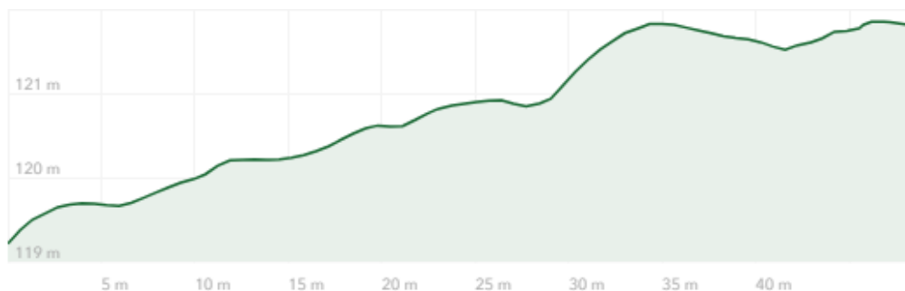
Figur 15. Terrengmodell / lengdeprofil bekk 7 nedstrøms kulvert.
