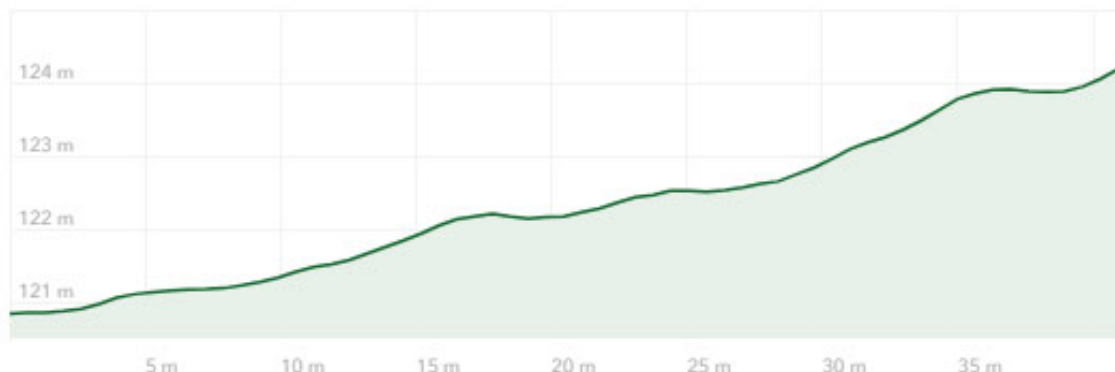
Figur 11. Terrengmodell / lengdeprofil av bekk 6 i tapt bekkestrekning (som ev. skal erstattes med kulvert).
