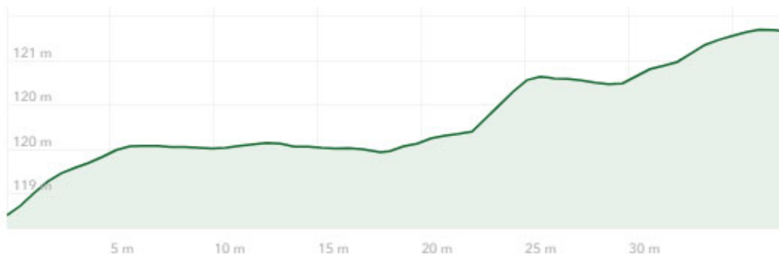
Figur 10. Terrengmodell / lengdeprofil av bekk 6 nedstrøms ny/planlagt kulvert.
