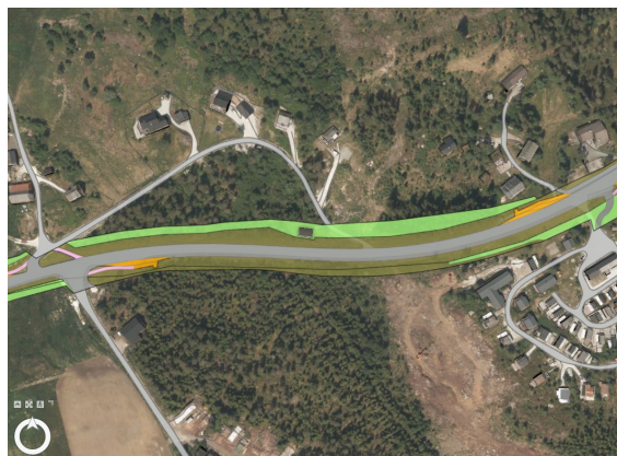
Figur 9 Ved Lundahovden er det lagt opp til erverv av sideterreng på 8 meter på nordsida av veg, på sørleg side er det planlagt for rekkverk og tilpassing til eksisterande plan Haugsvik camping
