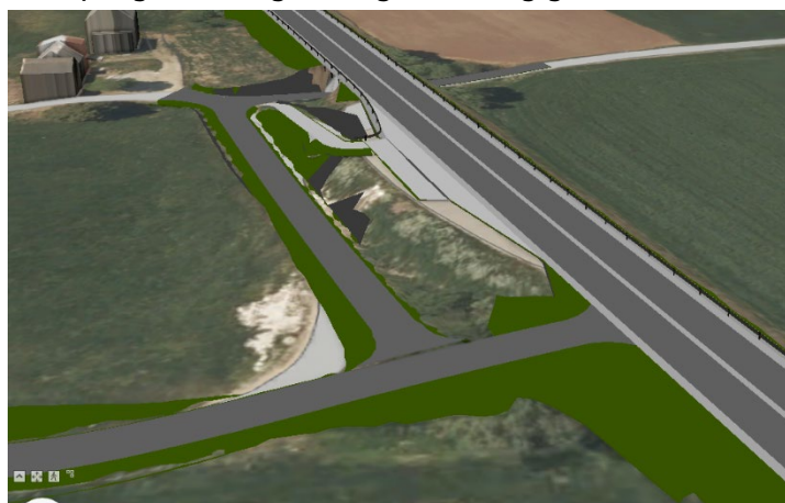
Figur 46 Avkøyring sørside veg til g/brn 329/1 og 328/1 er flytta 60 meter lenger aust.
