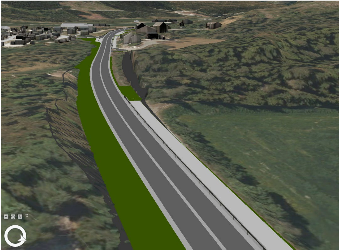
Figur 38 Dobbelsidige skjæringar ved profil 150
