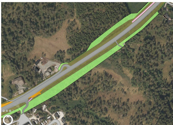
Figur 8 I dette området aust for Hagatun camping er det lagt opp til annan veggrunn på 8 meter (mørk grøn/brun farge)
