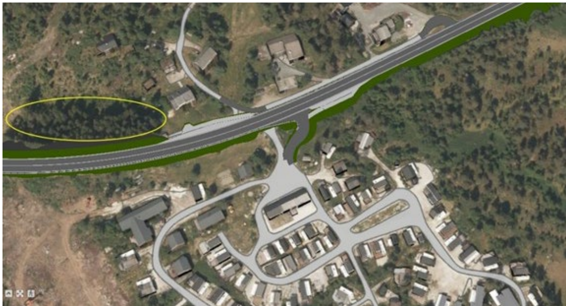
Figur39 Avkøyrslé til eigedomar på nordsida, Haugsvikvegen 170–186) er gjort noko djupare for å sikre framkomst for større køyrerøy
