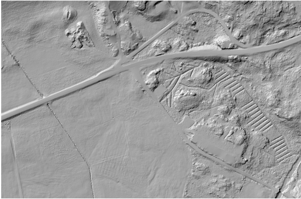
Figur 22 Synlege dreneringsgrøfter på Lidar, gravhaug (som ligg utanfor planområdet) øvst til venstre.
