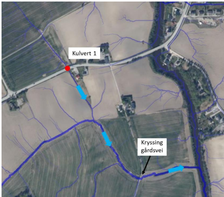
Figur 20. Flomvei nedstrøms kulvert 1.
