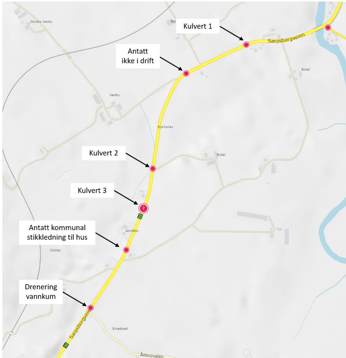
Figur 4. Oversikt over registrerte stikkrenner/kulverter på vegkart.no.
