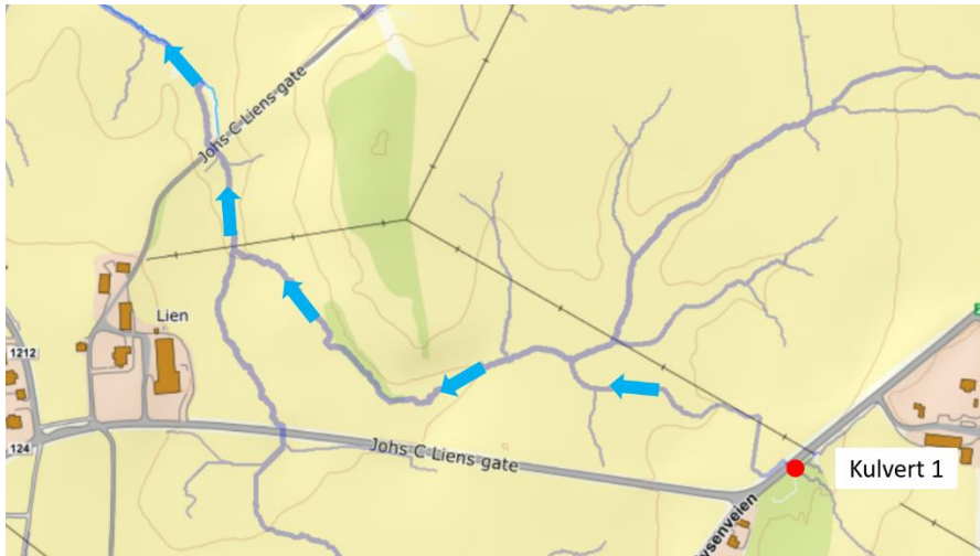
Figur 14. Flomvei nedstrøms kulvert 1.
