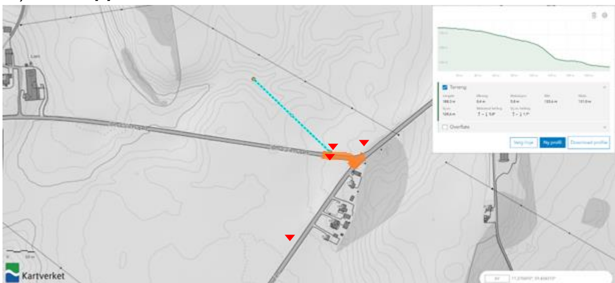
Figur 4 – Antatt kritisk snitt B. Oransje markering av tiltaksområdet. Raude trekantar viser omtrentleg plassering av sonderingar med påvist eller antyda sprøbruddmateriale. Analysert i hoydedata.no [9]
