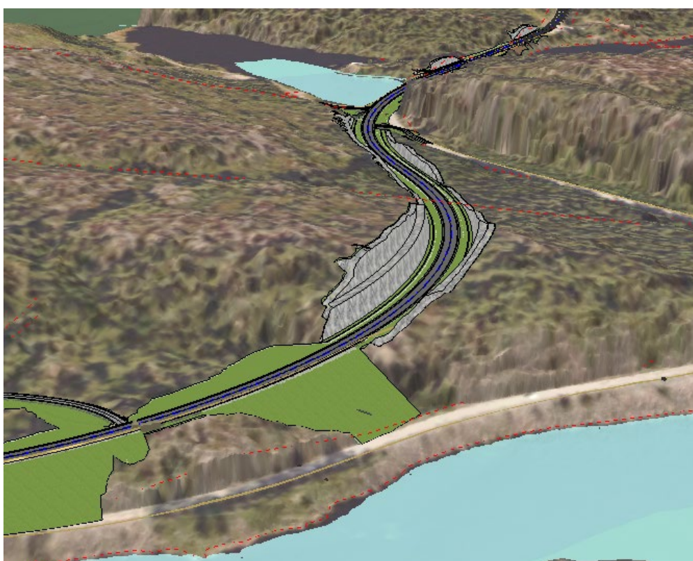
Figur 19. To-sidig skjæring over Stønurfjell. Hornskilen i forgrunnen, Pederstjønn lengre bak. 3D: Statens vegvesen.
