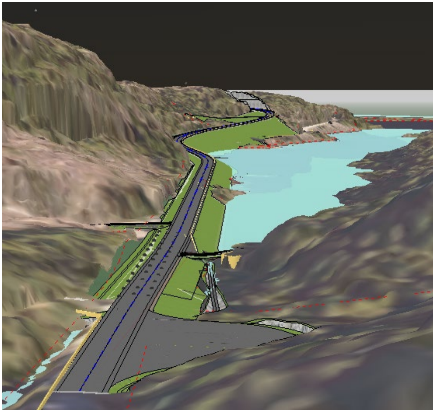
Figur 16 Utbedret rv. 9 sett fra Hornskilen sør. Snuplass for buss i forkant av bilde. 3D: Statens vegvesen.
