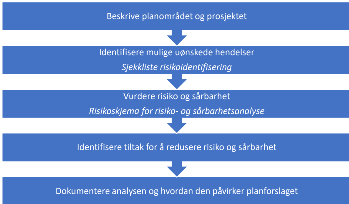
Figur 1 Trinnene i ROS-analysen etter figur i DSB-veilederen «Samfunnssikkerhet i kommunens arealplanlegging» (DSB, 2017).
