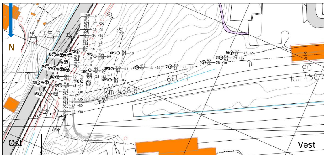
Figur 5: Omfang av grunnboringer ved planlagt tunnelpåkugg [11].
