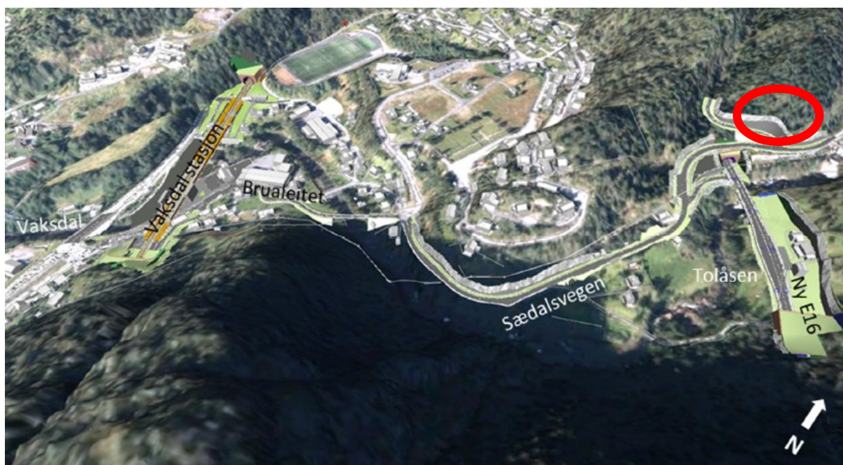
Figur 6: Bassengplassering Vaksdal B2. Ligger i fjellhall med adkomst fra sekundærveg.
