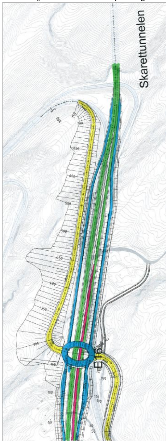
Figur 34: Feltreduksjon fra to til ett felt skjer på strekningen som vist med rødt
