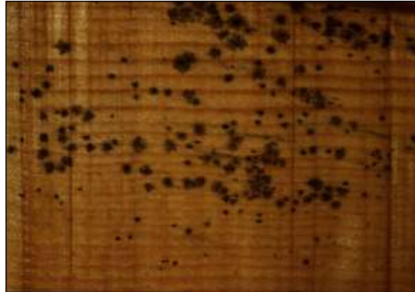
Bildet t.v. viser et furubord som er nybehandlet (1/2 år) med et tretjæreprodukt.
