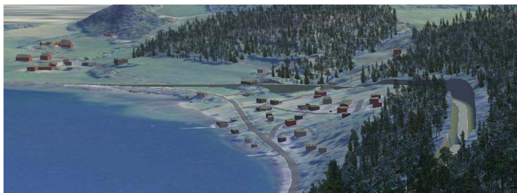
Fig 27, Illustrasjonen viser veglinja slik den vil kunne sjå ut når den går på oppsida av Klokkargarden, med fylling over Hestneselva.
