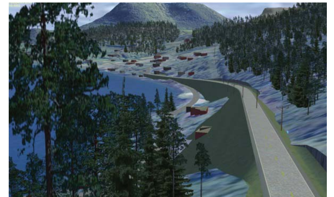
Fig 26, Illustrasjon viser fyllingsutslaget i møte mellom ny og gamal veglinje rett før Klokkargarden.
