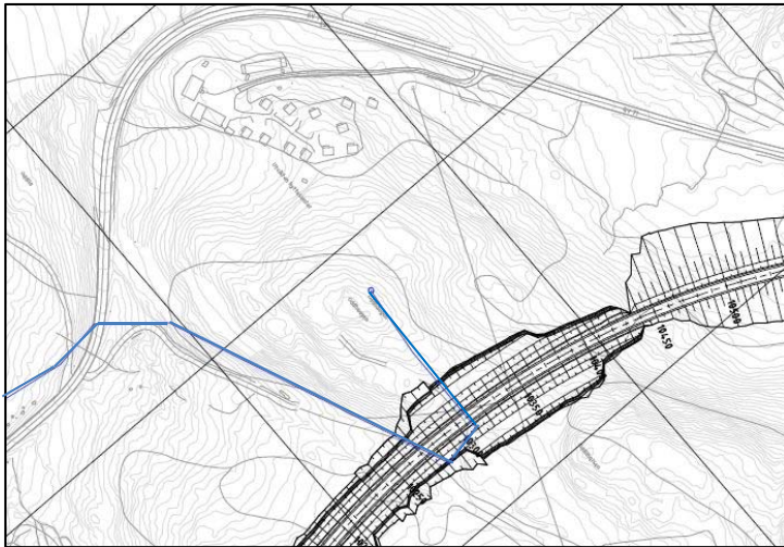
Figur 12 Kryssingspunkt for vassleidning (blått strek) ved Oddhaugen.
