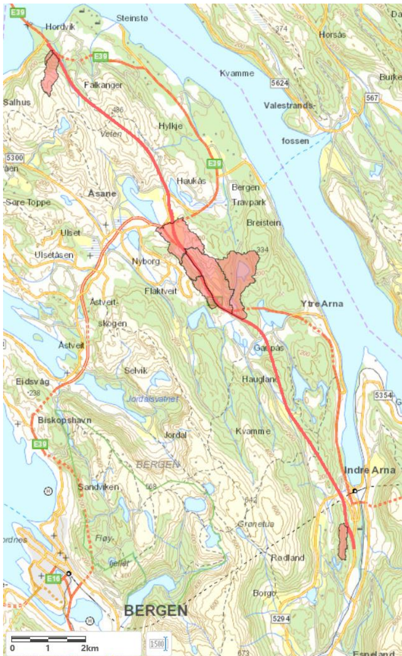
Figur 7-3: Vegtraséalternativ S3-N1. Røde områder viser nedbørfelt til alle vurderte kryssinger.
