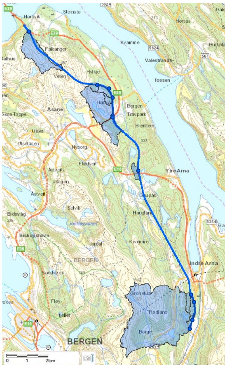
Figur 7-11: Vegtraséalternativ S9-N3. Blå områder viser nedbørfelt til alle vurderte kryssinger.
