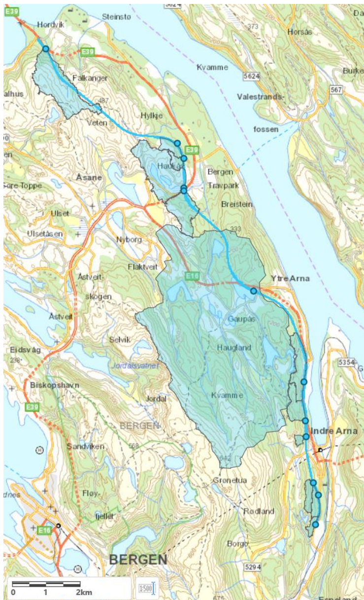
Figur 7-14: Vegtraséalternativ S11-N3. Blå områder viser nedbørfelt til alle vurderte kryssinger og brua Gaupåsvatnet.
