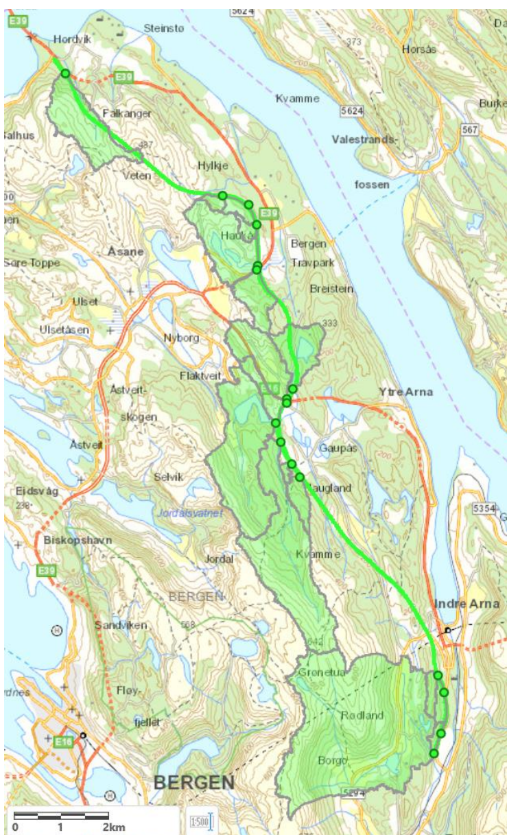
Figur 7-8: Vegtraséalternativ S6-N3. Grønne områder viser nedbørfelt til alle vurderte kryssinger.
