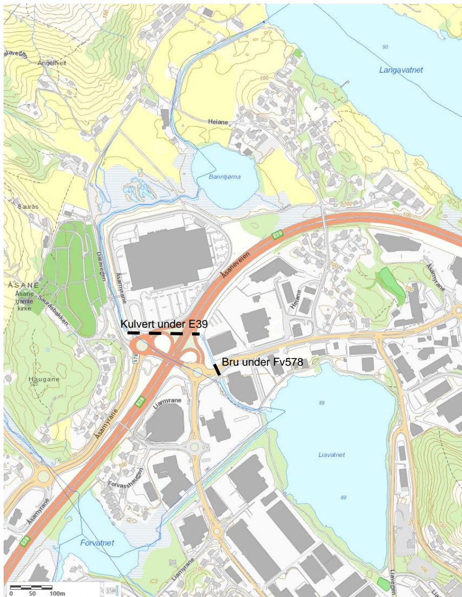
Figur 3-9: Vannvei nedstrøms Langavatnet. Fra Langavatnet sitt utløp renner vannet langs en 4 m bred kanal ned til Banntjørna. Elva renner videre til kulverten under motorveien E39 og bru under Fv578/Åsamyrane vei.
