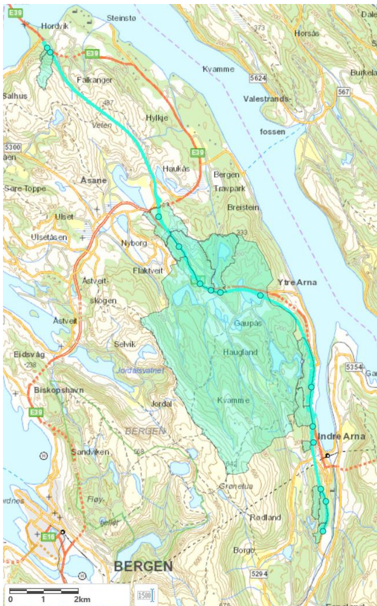
Figur 7-5: Vegtraséalternativ S5-N1. Lyseblå områder viser nedbørfelt til alle vurderte kryssinger og brua Gaupåsvatnet.
