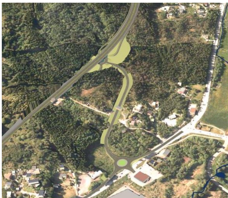
Figur 6-21: Utsnitt fra vegmodell av alternativ N2b med kryss og tilførselsveg i Haukåsskogen. Utsnitt tatt ovenfra og sør.
