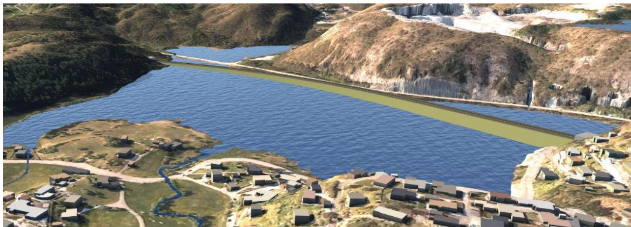
Figur 6-9: Utsnitt fra vegmodell av S5 ved Gaupåsvatnet. Modellen er noe misvisende fordi fyllingen i øst vil trolig bygges som bru. Utsnitt tatt fra sørvest.
