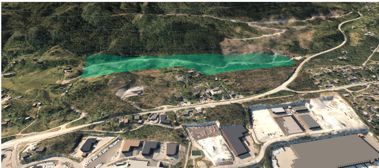
Figur 2-5. Figur øverst viser mulig utforming av deponi som separat deponi, nederste figur viser terreng under deponi.
