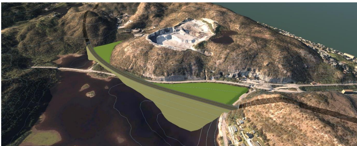
Figur 7-5 Figur nederst viser mulig utforming av deponi som sideareal til veg, øverst vises lokalisering i terreng uten deponi. Her er fylling vist til botn av innsjø.
