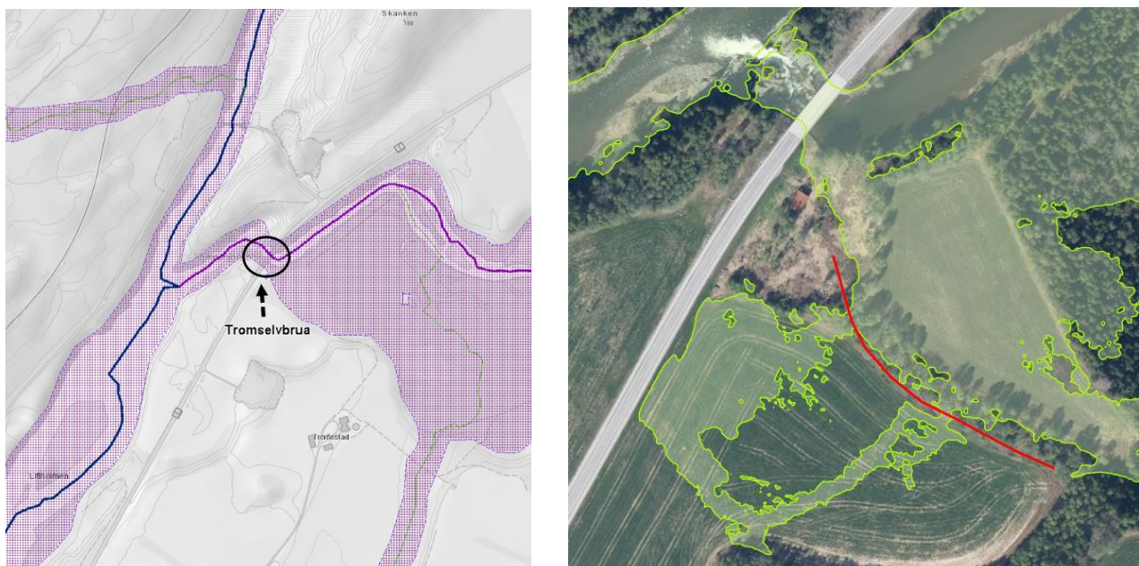
Figur 3-3. Flom aktsomhetskart (NVE, 2022) t. v, og flomsonekart som viser oversvømt område sør for brua ved 200-års flom. Kilde: Hydrologirapport, Sweco 22.03.2022.
