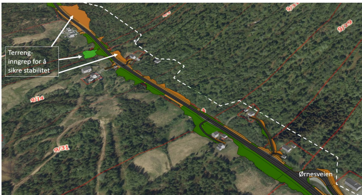
Figur 11. Illustrasjon som viser tiltak i området fra Bakkevoll til kryss Ørnesveien, sett mot nord.
