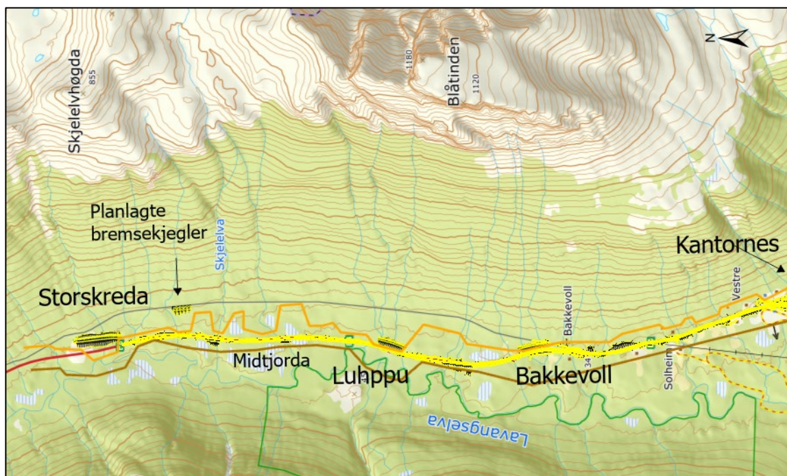
Figur 3 - Oversiktskart med planlagt ny veglinje (gul), skredvoller og bremsekjegler (gul og svart) per 25.01.2024. Strekninga er ca. 4 km fra Storskreda til Kantornes.
