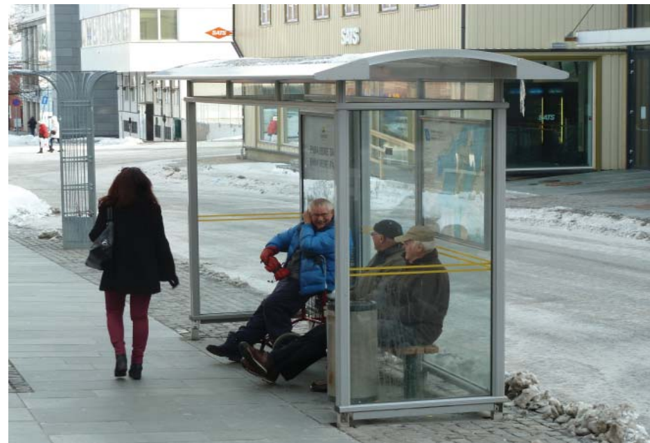
Tydlig inndeling i gangareal med slett underlag og møblingssone med ujevnt dekke. Møblingssonen fungerer også som naturlig ledelinje og et slags varselfelt mot vegen. Buskuret som er plassert med bakvegg mot vegen skjermer mot sprut og reduserer støy mens man venter.
