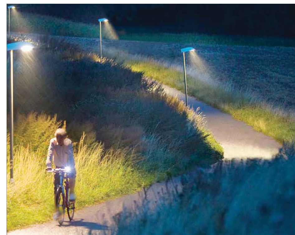
Master langs gang- og sykkelveg bør generelt være lavere enn vegmaster
