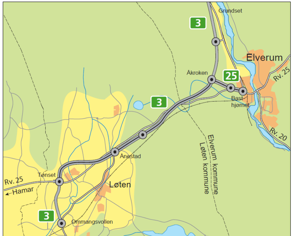
Figur 1.2: Oversiktskart som viser planlagt utbygging av ny rv 3 og rv 25 mellom Ommangsvollen og Grundset. Sirkler viser planlagte kryss (både planskilte og kryss i plan), mens doble streker viser planlagte firefeltstrekninger.
