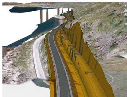
Høye bergskjæringer langs Grøtneslandet skal trappes ned.
